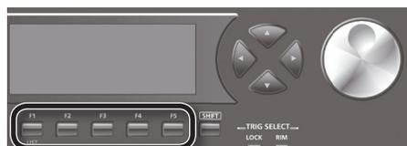
Кнопки [F1] – [F5] называются "функциональными". В нижней строке экрана отображаются функции, назначенные на кнопки [F1] – [F5]. Например, если в руководстве упомянута кнопка [F2] (EDIT), нажмите кнопку [F2] (в этом случае на экране над кнопкой [F2] отображается надпись "EDIT").
