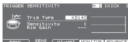
Монитор силы удара в правой части экрана позволяет отслеживать параметр Velocity ударов по пэду.
