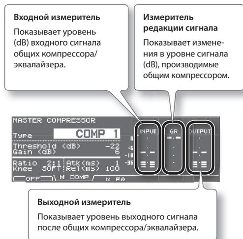
С помощью параметра "Gain" компрессора установите такой уровень, чтобы показания выходного измерителя не превышали 0 dB (т.е., чтобы избежать перегрузки).
